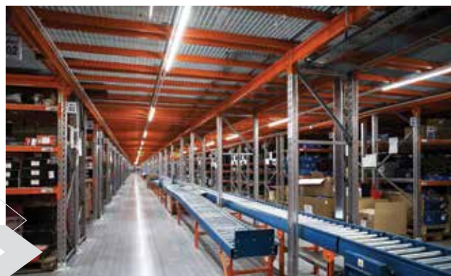
Połączenie linii przenośnikowej z zabudową regałów półkowych X-S Max.
