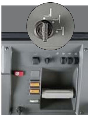
Przełącznik kluczykowy wyboru strefy umożliwia bezpieczne wybieranie spośród trzech wcześniej ustawionych limitów podnoszenia.
